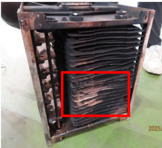
靜電場極板起火點(碳化嚴重的地方)，圖片來源：職業安全衛生署
