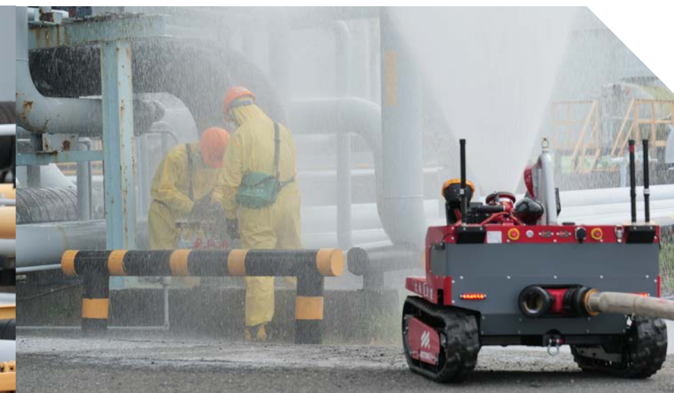
在消防機器人防護之下，止漏人員模擬演練以管夾進行管線止漏作業
